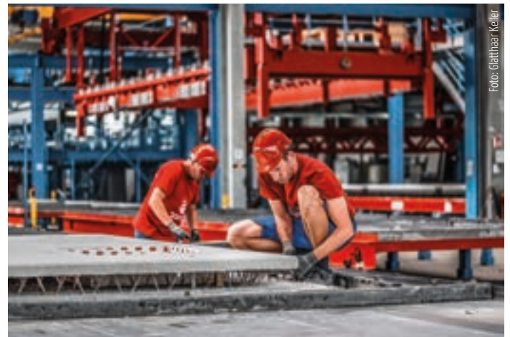
Industriell vorgefertigte Betonwände sind dünner als gemauerte tragende Innenwände. Das schont auch Ressourcen.
