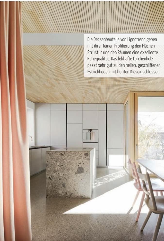
Die Deckenbauteile von Lignotrend geben mit ihrer feinen Profilierung den Flächen Struktur und den Räumen eine exzellente Ruhequalität. Das lebhaftes Lärchenholz passt sehr gut zu den hellen, geschliffenen Estrichböden mit bunten Kieseinschlüssen.
