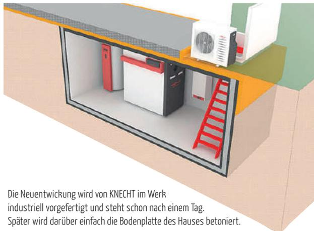
Die Neuentwicklung wird von KNECHT im Werk industriell vorgefertigt und steht schon nach einem Tag. Später wird darüber einfach die Bodenplatte des Hauses betoniert.
