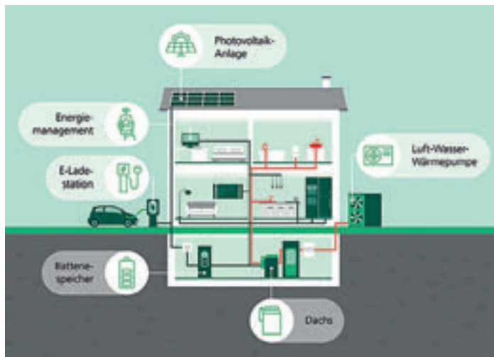
Abbildung 3: Dachs-Heizungsanlage mit Batteriespeicher, Wärmepumpe und PV-Anlage. Im Winter liefert der Dachs Strom für die Batterie & Wärmepumpe wohingegen im Sommer die PV-Anlage den Strom liefert
